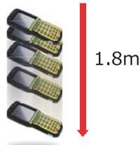
悪天時の屋外運用や粉塵環境での運用に耐えるIP67に適合しています。また、1.8mの高さからコンクリート面への複数回落下、1mから2000回の転倒衝撃テストをクリアしています。
