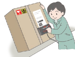
大きな対象物のバーコードも、自由な角度で検証可能。
