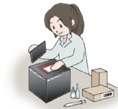
ラベルの他、ビンや缶などのボトルパッケージ、アンプル、バイアル、試験管などの立体物もOK。ガラス上に検証対象物を置き、マウスでエリアを指定するだけでグレード検証ができます。
