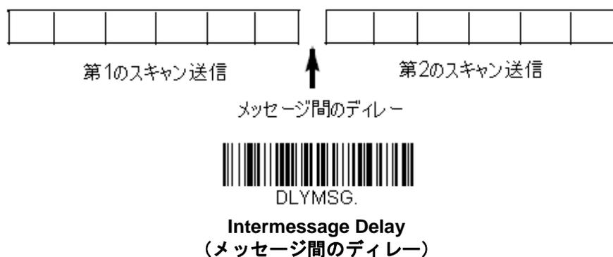
この間隔を削除するときは、**Intermessage Delay（メッセージ間のディレイ）** のバーコードを読み取り、次に感覚を 0 に設定します。その後、本書の裏表紙の内側にあるプログラミングチャートで **Save（保存）** のバーコードを読み取ります。
