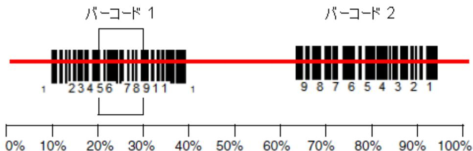
**Centering On** (センタリング有効) を読み取り、次のバーコードのいずれかを読み取ることでセンタリングウィンドウの左右いずれかが変更できます。次に本書の裏表紙の内側にある数字を用いて、センタリングウィンドウを移動するパーセンテージを読み取り、その後 **Save** (保存) を読み取ります。
