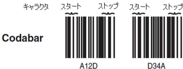
連結されていない単独の「D」Codabar をデコードしないようにするには、**Required (要求する)** を選択します。この選択をしても、「D」のスタート/ストップキャラクタがない Codabar には影響ありません。
