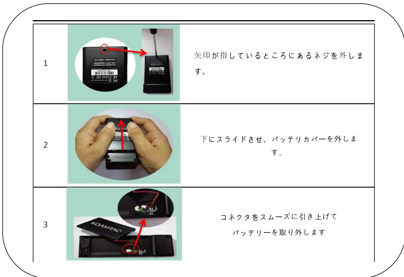
図 18-KDC 電池を交換する
