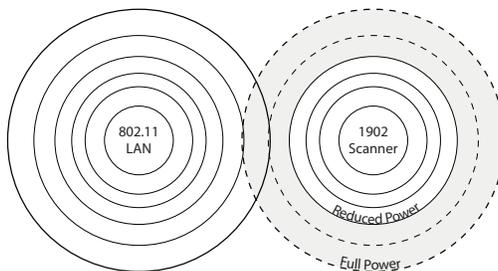
下記のバーコードの1つを読み込むことで、以下のいずれかの出力を選択して設定することができます。完全出力（100%）[2.5mW、4dBm]、出力 - 中（35%）[0.875mW、0dBm]、出力 - 中低（5%）[0.125mW、-9dBm]、出力 - 低（1%）[0.025mW、-16dBm] 初期設定 = Full Power（フルパワー）
