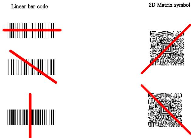
エイミングビームは、スキャナがバーコードに近づくと小さくなり、遠ざかると大きくなります。パーまたはエレメントが小さなシンボル（ミルサイズ/分解能）はスキャナを近づけて読み取り、大きなシンボル（ミルサイズ/分解能）は離して読み取ってください。1個または複数のシンボル（1ページまたは1個の物体の）を読み取る時は、目標から適切な距離でスキャナを保持し、トリガを引き、エイミングビームをシンボルの中心に合わせてます。読み取るバーコードの反射が大きい場合は（ラミネートされている場合など）、無用な反射を避けるため、バーコードを15度～18度傾けることが必要な場合があります。
