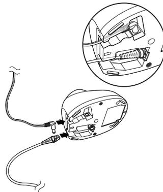
5. 新しいケーブルと交換します。コネクタを穴に差し込んで確実に押し込みます。コネクタには、一方向だけに入るようにキーが付いています。所定の位置でカチッと音がします。
