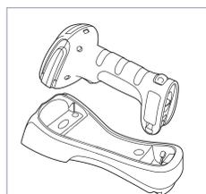
スキャナ本体のトリガーを引き、クレードルにセットしてください。自動でペアリングされます。クレードルに貼られた12桁のバーコードを読み取ることで強制的にペアリングをさせることも可能です。
