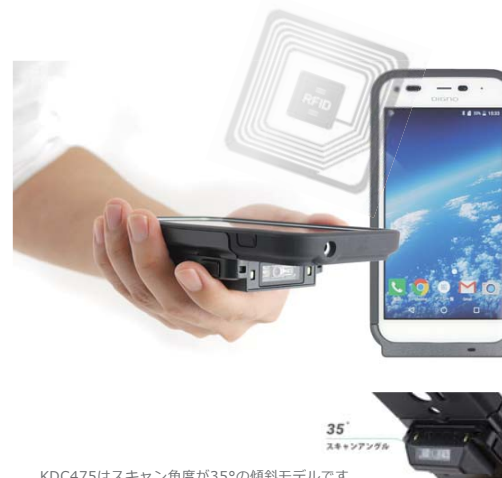
KDC475はスキャン角度が35°の傾斜モデルです。
