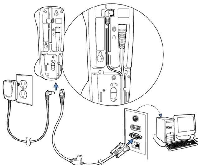
4. シリアルコネクタをコンピュータのシリアルポートに差し込みます。2本のネジを締めてコネクタをポートに固定します。
