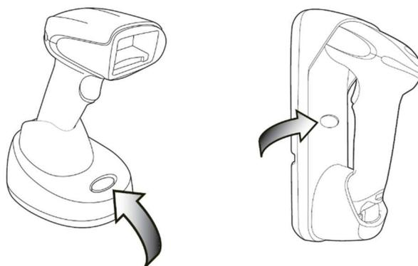
ベースまたはアクセスポイントのページボタンを押すと、そのベースまたはアクセスポイントに接続しているスキャナがストリーミングプレゼンテーションモードに設定されている時は、スキャナのエイマーは直ぐに消えますが、スキャナの光は点灯を続け、何時でもバーコードを読取れる状態をキープしています。テンポラリストリーミングプレゼンテーションモードの時は、ベースのページボタンを押すとスキャナはタイムアウトするまで、ストリーミングプレゼンテーションモードになります。タイムアウトになる前にバーコードを読取ると、タイマーはリセットされます。
