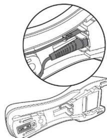
5. 新しいケーブルと交換します。コネクタを穴に差し込んで確実に押し込みます。コネクタは一方向だけに入るように設計されており、所定の位置でカチッと音がします。
