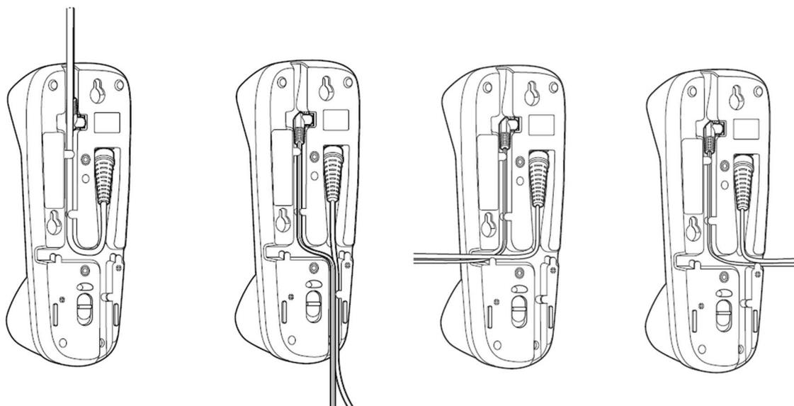
垂直面に設置する場合、ロックシステムでスタンドに置いたスキャナを保護します。水平面に取り付ける場合、ロック機構はロック解除（押し下げ）に設定する必要があります。垂直面に取り付ける場合、ロック機構はロック（押し上げ）に設定する必要があります。
