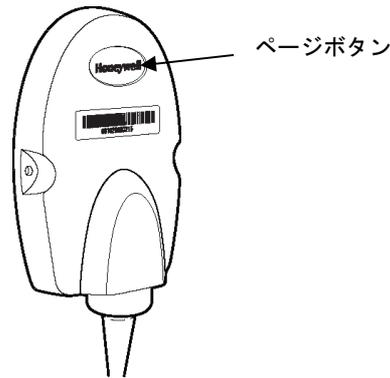
アクセスポイントの上部にあるリンクバーコードを読み取り、アクセスポイントとスキャナ間の接続を確立します。スキャナは短いピープ音を発し、緑のLEDが点滅してアクセスポイントの接続が確認できます。アクセスポイントのページボタンは青色のままです。
