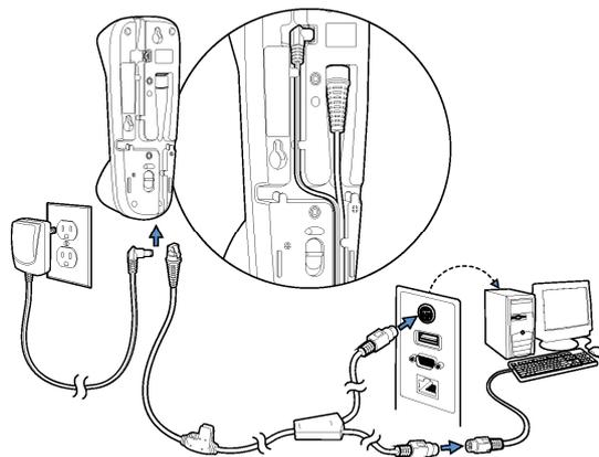
4. 端末/コンピュータの電源をオンにします。スキャナからピーツという起動音がします。
